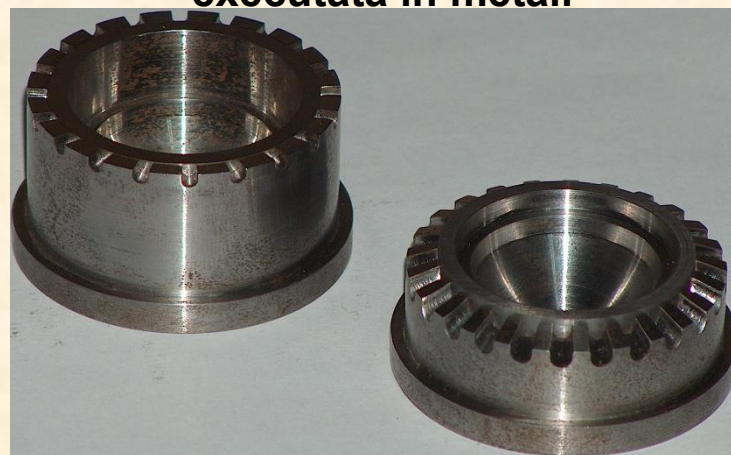
Complete de matrițe din forma de turnare.
