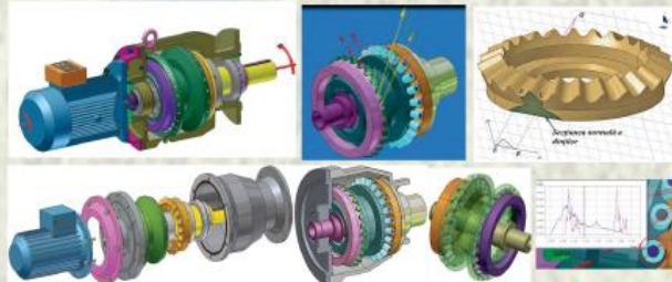
Soluția tehnică 1: Nodul arbore-manivelă instalat cu autoșezare
